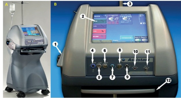
Şekil 1: Optikon 2000 S.p.A. (ASSISTANT) vitrektomi sisteminin genel görünümü (A) ve önden görünümü (B) 1) İrigasyon aspirasyon sistemi, 2) Dokunmatik ekran, 3) Aski sistemi, 4) Diatermi yuvası, 5) U/S (fako) yuvası, 6) Mikro makaslar yuvası, 7) Hava yuvası, 8) Vitrektomi yuvası, 9) Silikon enjeksiyonu yuvası, 10) Optik fiber yuva, 11) Optik fiber yuva, 12) Cerrahi cihazlar için tepsi. 5
