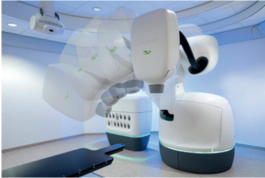
Şekil 2: Stereoskopik Robotik Radyocerrahide kullanılan Cyberknife cihazı.
