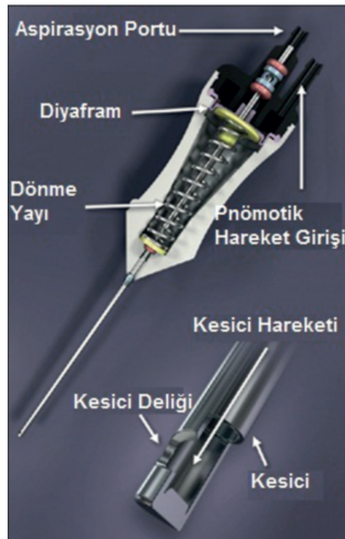
Şekil 10: Pnömatik giyotin vitrektör sisteminin çalışma dizaynı gösterilmektedir.
