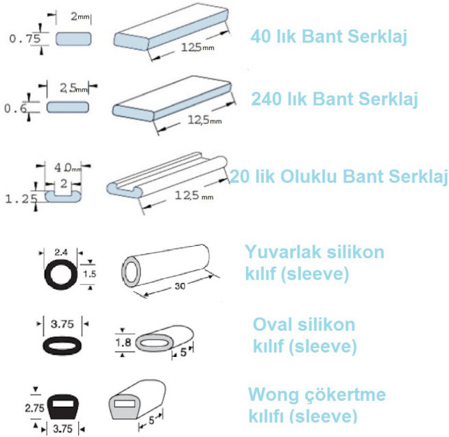
Resim 3. Farklı geometrik özelliklerdeki solid silikon yapılarındaki eksplantlar.
